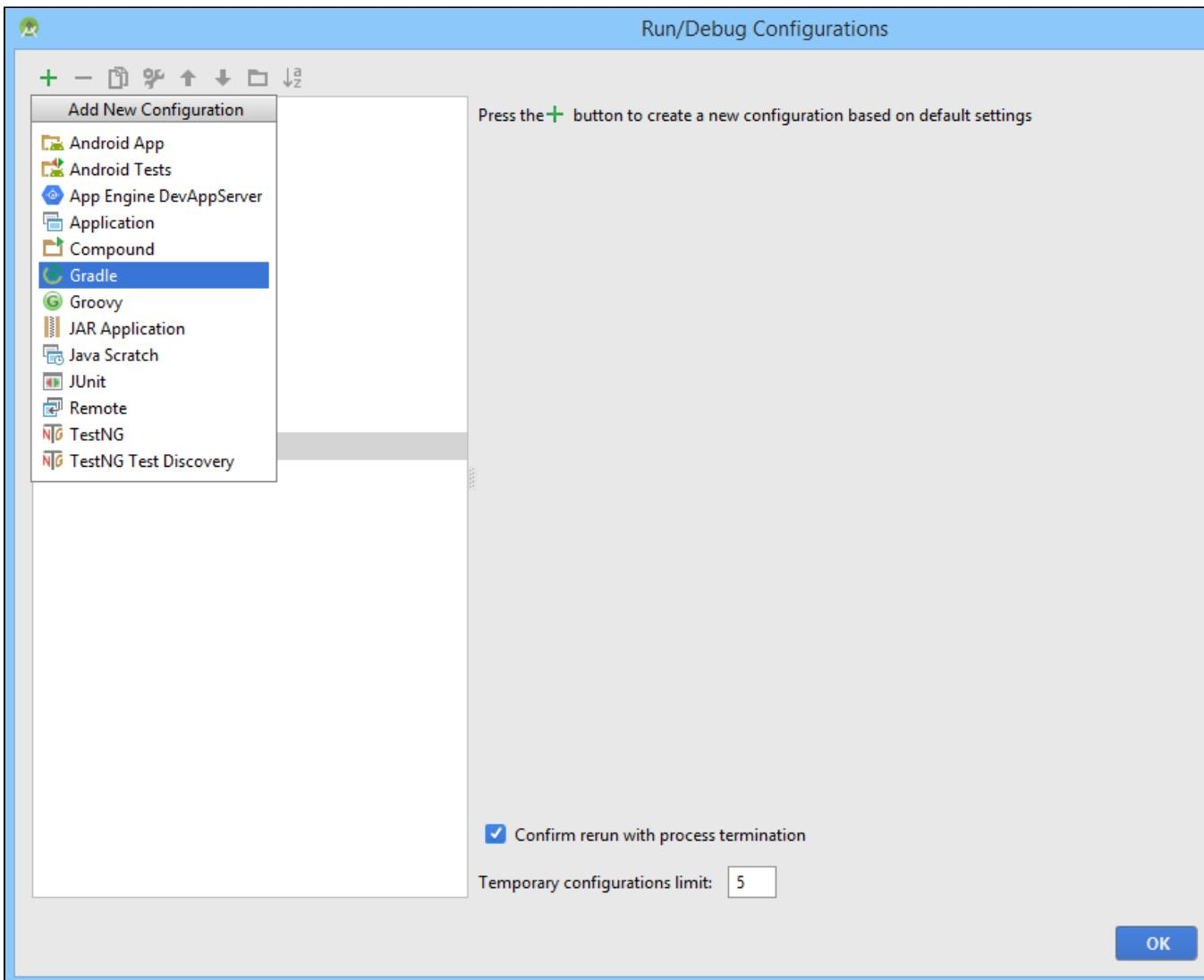
4. Для конфигурации запуска укажите файл сборки build.gradle, название сборки и назначение: build
