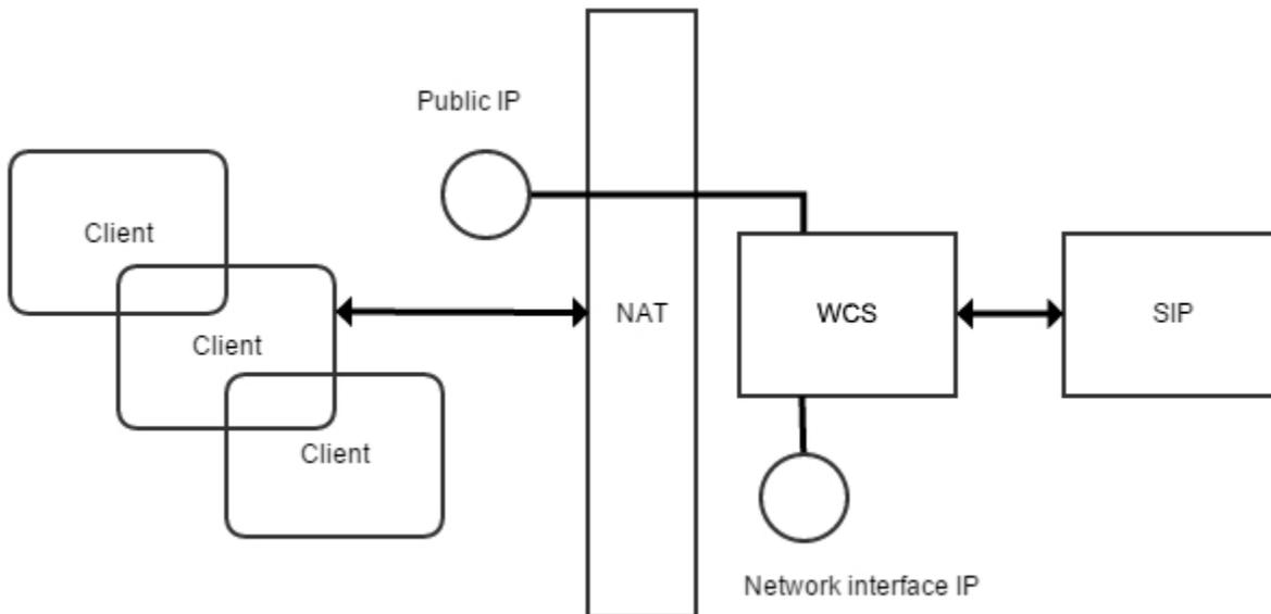
При размещении WCS сервера за NAT, понадобится определить два IP адреса.
