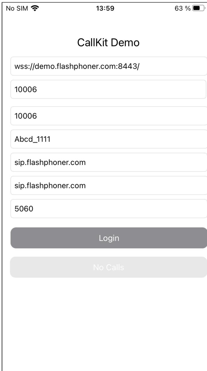
При входящем звонке приложение получает пуш-уведомление, даже если оно свернуто или закрыто. Если приложение закрыто, оно подключается к SIP-сессии на сервере с токеном, полученным в уведомлении, и принимает входящий звонок.
